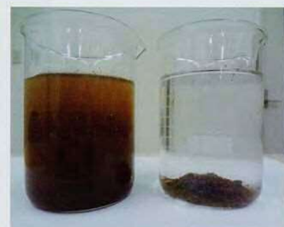
右汚水に左のみ凝集剤を加えて混ぜた3分後の写真
